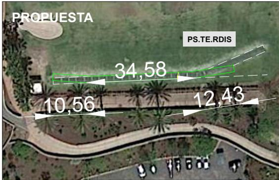
Plano arriba, trazo discontinuo plataforma actual; trazo verde propuesta, de izquierda a derecha: los primeros diez metros a la izquierda de la plataforma estarían girados un ángulo de **7 grados** hacia el interior del campo de prácticas. Los siguientes treinta y cuatro metros, lineales. Y los restantes doce metros girados nuevamente un ángulo de **7 grados**.
